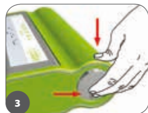
Figura 3: prima di tutto fate pressione con il polso sulla parte superiore della macchina (nello stesso punto in cui avete premuto per il blocco), quindi premete con le dita sulla piastra tonda interna, posta sul lato della macchina.
