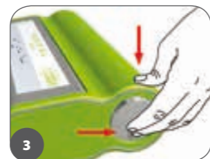
Slika 3: Prvo pritisnite dlanom gornju površinu aparata (na istom mestu kao kada zatvarate aparat) i zatim prstima pritisnite okruglu ploču koja se nalazi sa bočne strane aparata.
